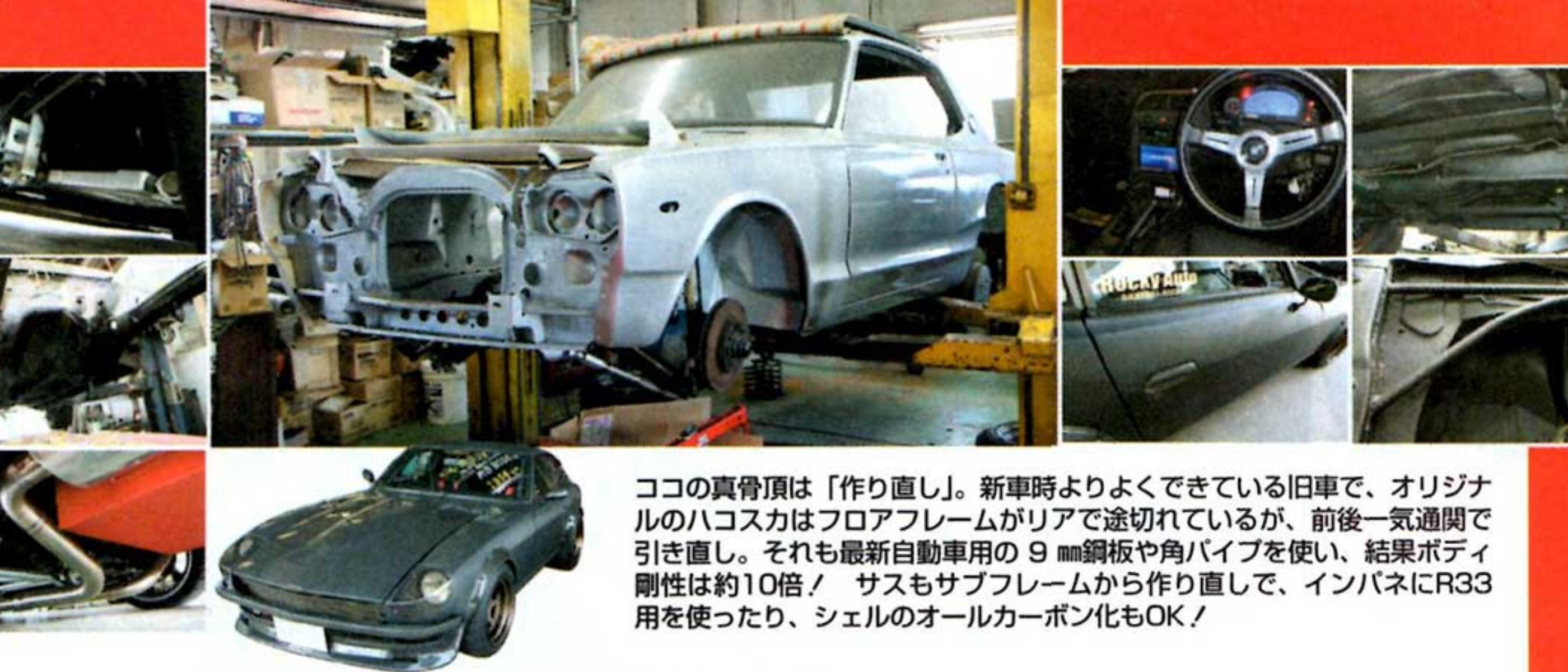
ココの真骨頂は「作り直し」。新車時よりよくできている旧車で、オリジナルのハコスカはフロアフレームがリアで途切れているが、前後一気通貫で引き直し。それも最新自動車用の9mm鋼板や角パイプを使い、結果ボディ剛性は約10倍! サスもサブフレームから作り直して、インパネにR33用を使ったり、シェルのオールカーボン化もOK!
